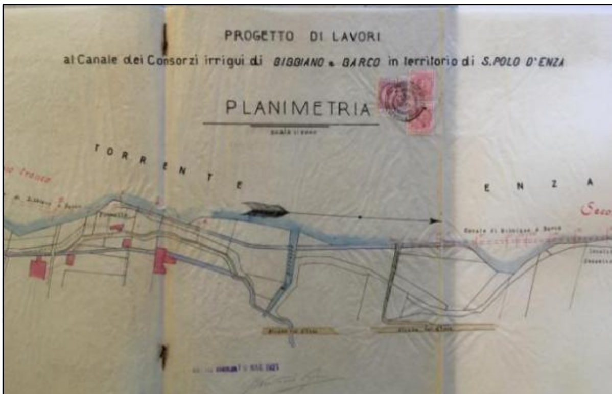
Figura 35: Planimetria progetto nuova Galleria Filtrante su Canale di Bibbiano - Archivio Consorzio Irriguo di Bibbiano (1921).
